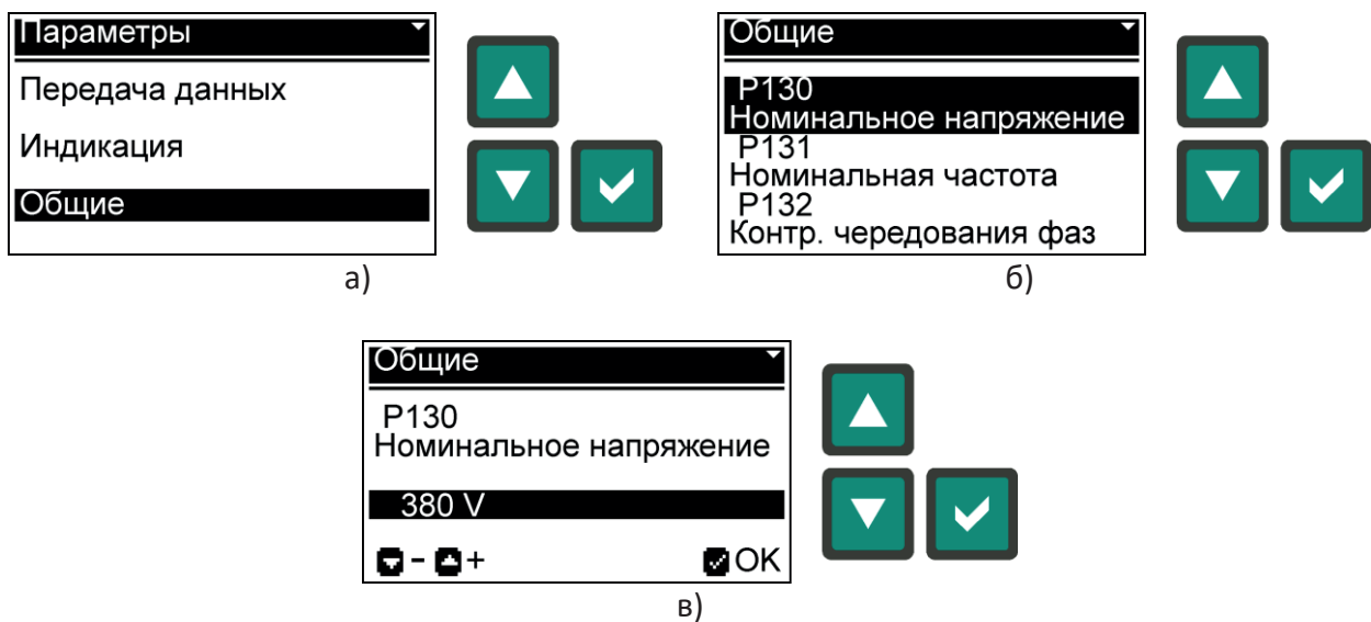
Рис. 5.15. Пример изменения параметра P130 - «Номинальное напряжение»: а) выбор группы параметров; б) выбор параметра; в) изменение параметра.
